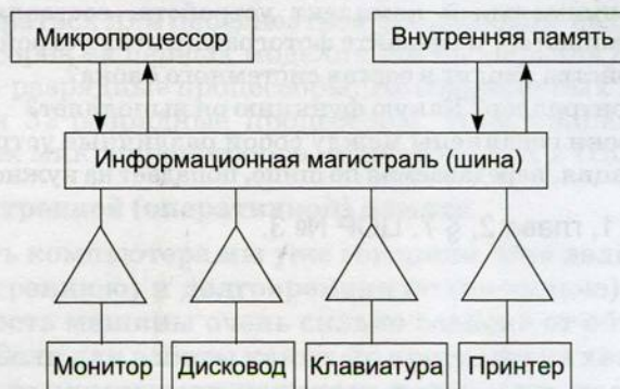
Рис. 2.9. Структура ПК (треугольниками изображены контроллеры)
